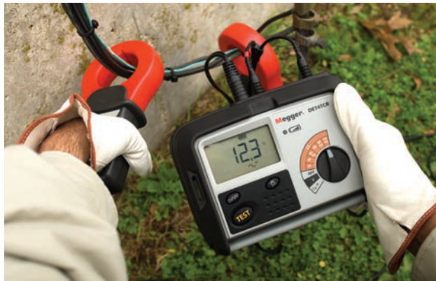
图中所示DET4TCR2可使用钳表进行无桩测试。
