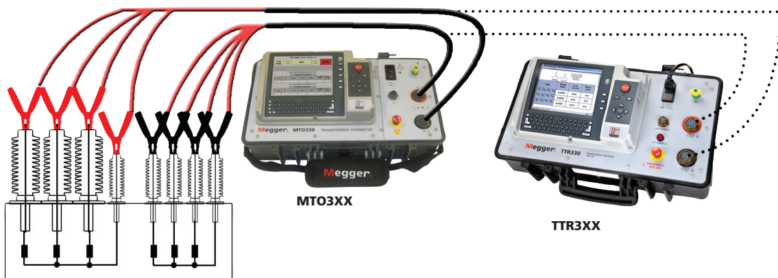
此图显示MTO3XX系列和TTR300系列能轻松方便地使用同一套测试引线。例如，用户可以留下连接到变压器的引线，并使用相同的引线设置与Megger TTR3XX系列进行匝数比测试，无需重复上下梯子。
