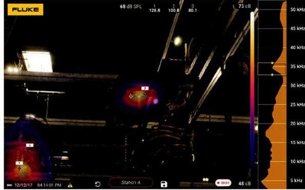
最初，Genie 测试 Fluke ii900 工业声学成像仪的主要目的是节能。在初次空气泄漏检查和修复之后，Stockert 看到其压缩空气容量恢复了 25.7%。“我们接近了压缩机系统能够提供的极值。”他介绍说：“通过修复利用 ii900 发现的泄漏，我们总共四台压缩机中有一台在很大部分时间内都处于闲置状态。”减少压缩机的使用，预计每年可节省 48,754 美元的电费。
